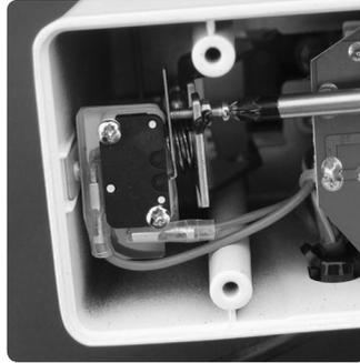
4. Drehen Sie die Schraube im Uhrzeigersinn, bis die Schraube beim Herunterdrücken des Schweißarmes den Mikroschalter betätigt (ca. 1 - 2 Umdrehungen). Ziehen Sie dann die Mutter wieder an und verschrauben Sie die Bodenplatte.
